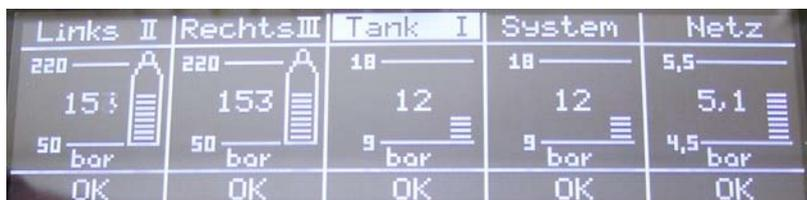
Das LCD zeigt die Quellenbezeichnungen, die Alarmgrenzen und den aktuellen Druck an. Desweiteren ist die Quellenreihenfolge, die für die Umschaltung relevant ist, durch römische Ziffern dargestellt. Die z.Zt. aktive Quelle wird durch Invertierung der Quellenbezeichnung angezeigt. Im unteren Bereich der Anzeige wird der Status des jeweiligen Druckes nochmals in Textform dargestellt (OK, HIGH, LOW).
