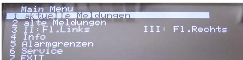
Mit den Tasten HOCH und RUNTER kann der gewünschte Eintrag ausgewählt werden (inverse Darstellung). Durch Drücken der ENTER-Taste wird in das entsprechende Untermenü gewechselt. Das Hauptmenü kann über auswählen von „7 EXIT“ und betätigen der ENTER-Taste verlassen werden. Ferner kann das Hauptmenü über die QUITTIERUNGS-Taste verlassen werden.
